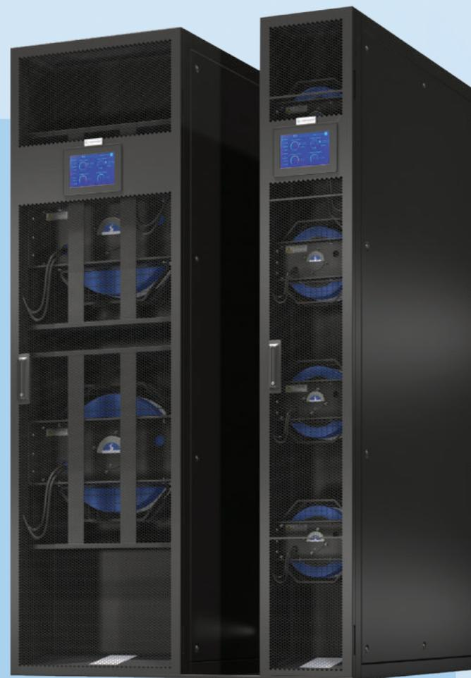
В данной линейке прецизионных кондиционеров есть возможность заказа оборудования в нестандартных габаритных модификациях. На устройства глубиной 1000 мм возможна установка увлажнителя производительностью 3 кг/ч, как и для стандартного размера 1200 мм.
